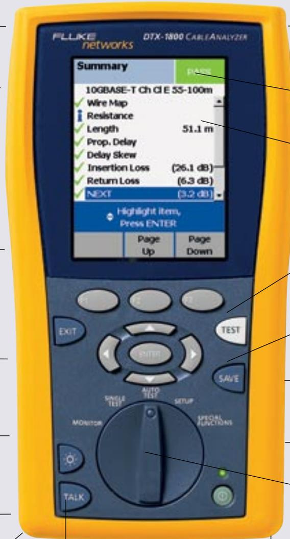
**Unterstützte Bandbreite bis zu 900 MHz** – für Video-Verteilanlagen, Class F und 10 Gigabit Ethernet.
