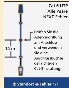
was wo zu tun ist, damit der Link den Test besteht. *Selbst wenn nur 2 % der Kabel in einer Schicht den Autotest nicht bestehen, sparen Sie täglich bis zu 2 Stunden Arbeitszeit bei der Zertifizierung.*
